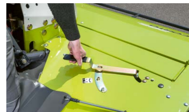
Réglage simple des disques à andain.
